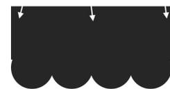
**STABUFLEX® Bogenschnitt** sollte mit zwei Nägeln befestigt werden. Dabei sollten die Nägel nur durch eine Platte geschlagen werden. Die genauen Positionen ergeben sich durch die Höhen- und Seitenüberdeckung.
